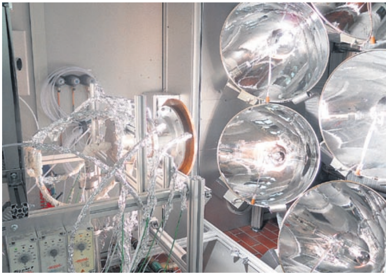
Ein Wunderding: Forscher der ETH Zürich stellen mittels dieses Solarreaktors umweltfreundlichen Flüssigtreibstoff her. Bild: pd
